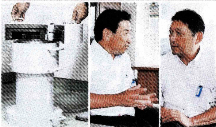
⑤テクノヒルが提供した微量放射能測定器。自然放射線のノイズを遮断するため厚さ約50 mm の鉛遮蔽体で囲われており、質量240 kg と持ち上げられないほど重い。⑥テクノヒルの鈴木社長。⑦いちいの伊藤社長(山根一眞撮影)
